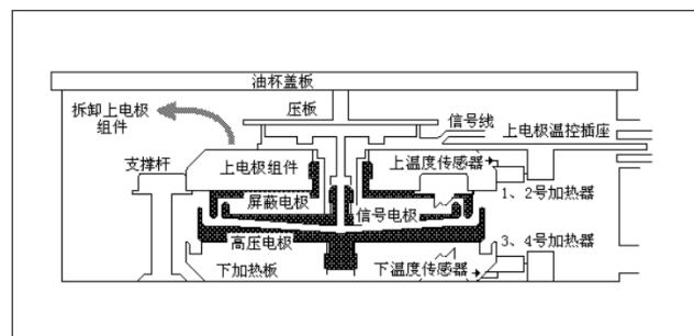
AI-6000油介损电阻率测量仪油杯结构图
