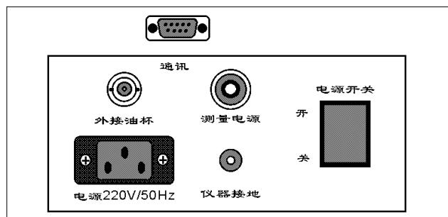
AI-6000油介损电阻率测量仪侧面板
